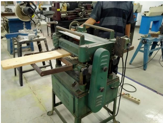
Gambar 3. Proses penghalusan tahap 2
