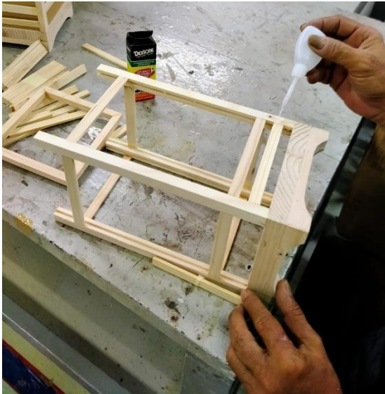
Gambar 6. Hasil perakitan yang telah memperlihatkan struktur bentuk lampu meja
