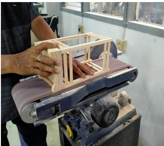
Gambar 7. Proses menghaluskan permukaan struktur lampu meja
