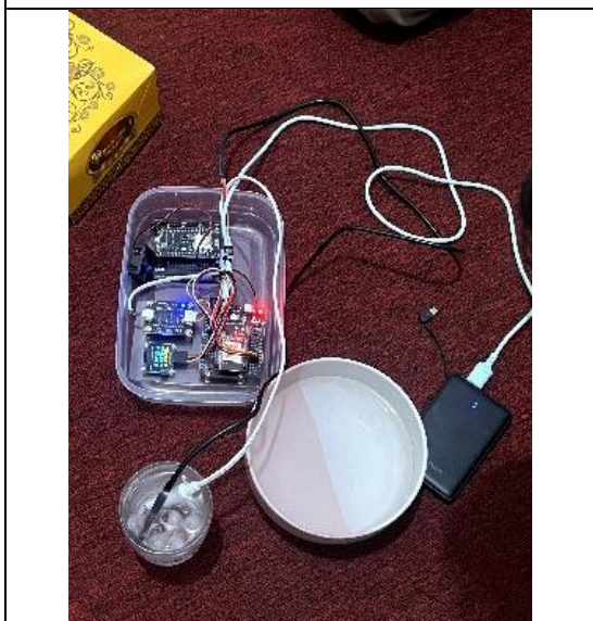
Gambar 6. Kegiatan Pelaksanaan Kedua yaitu pempapatan alat arduino uji kualitas air.
